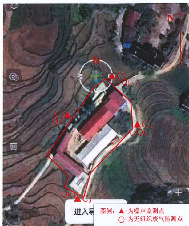
图1 重庆鼎发实业集团股份有限公司大雷增压站检测布点示意图
