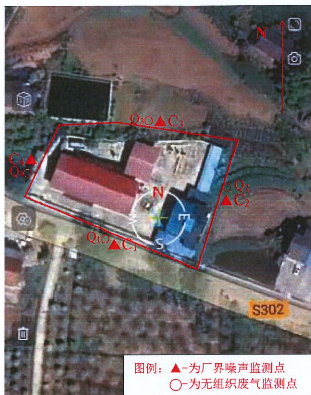
图 1 重庆鼎发实业集团股份有限公司五洞增压站检测布点示意图
