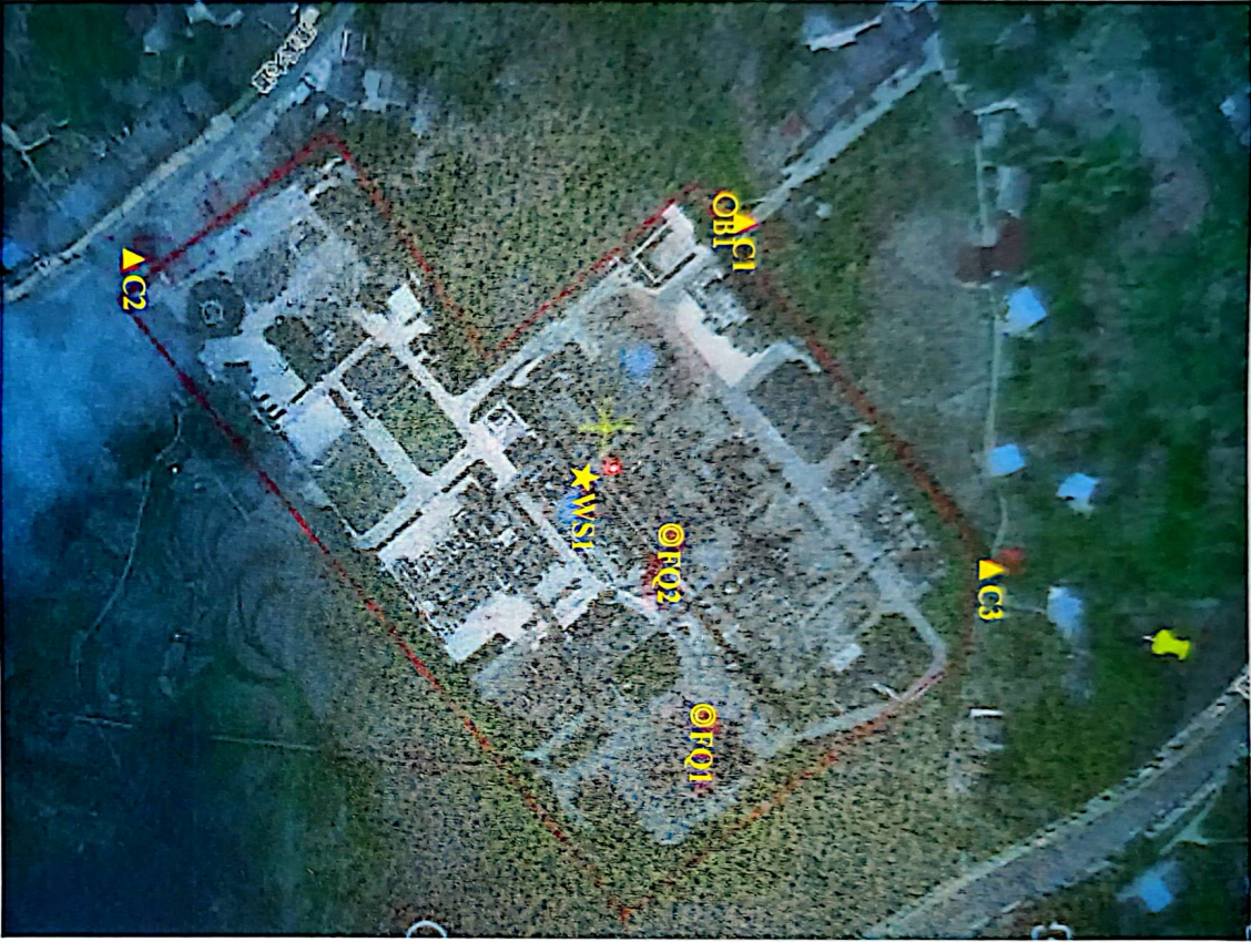
图例：★—废水监测点，◎—有组织废气监测点，○—无组织废气监测点，▲—厂界噪声监测点
